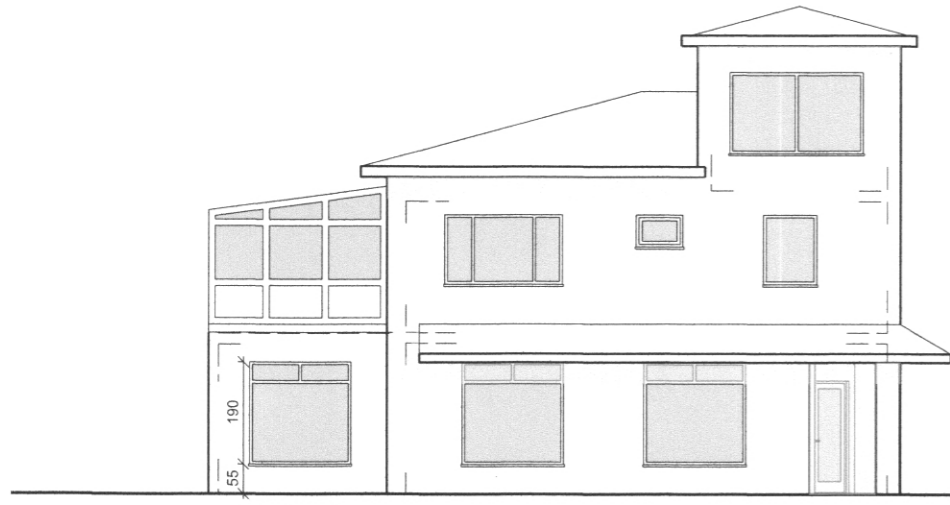
Nýr gluggi í útvegg Bílskúrshúð fjarlægð
